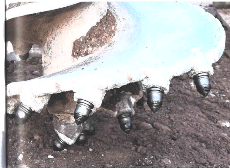
Bohrschnecke mit gepanzerten Rundschaftmeisseln.
